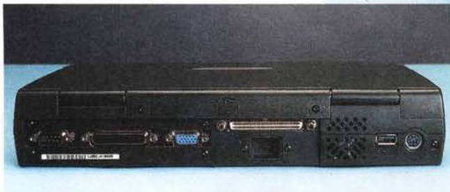
Retro dell'apparecchio: i vari connettori per il collegamento delle periferiche esterne; la mancanza di uno sportello di protezione, a detta di Compaq, non pregiudica l'incolumità di questi componenti. A lato del connettore proprietario per la docking station (compatibile con quello dei modelli precedenti) si può notare la griglia di protezione della ventolina per il processore.
